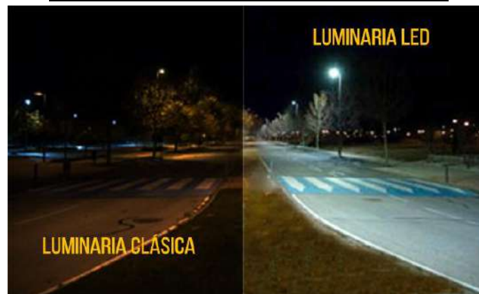
FIGURA 68. LUMINARIA CLÁSICA VS LUMINARIA LED
