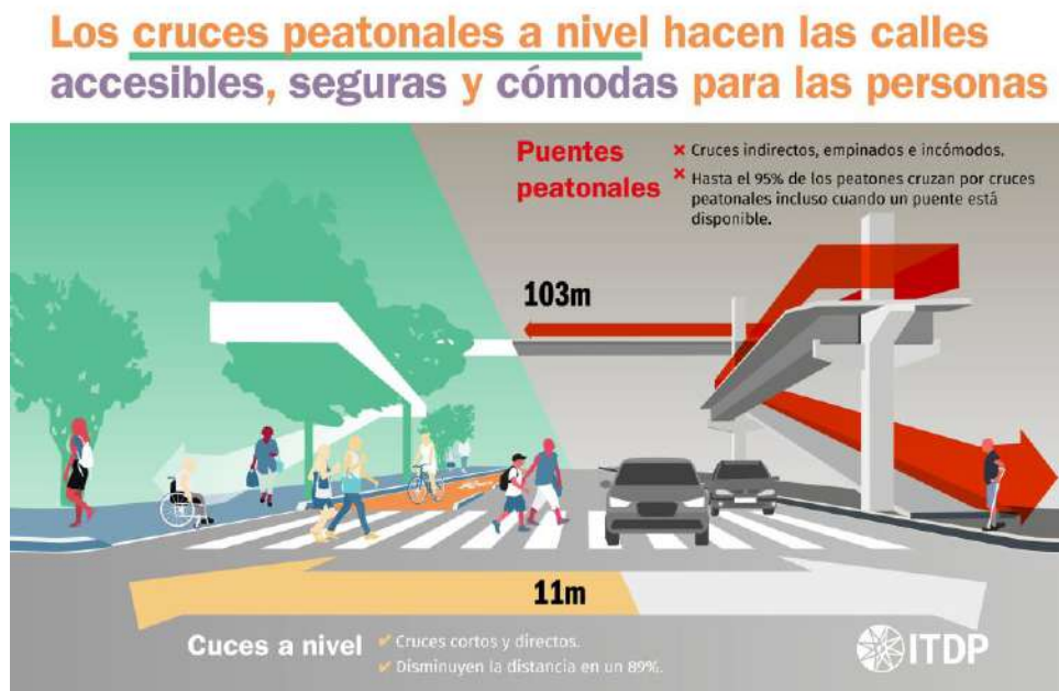
FIGURA 15. DIFERENCIA ENTRE CRUCES PEATONALES Y PUENTES ANTI PEATONALES
