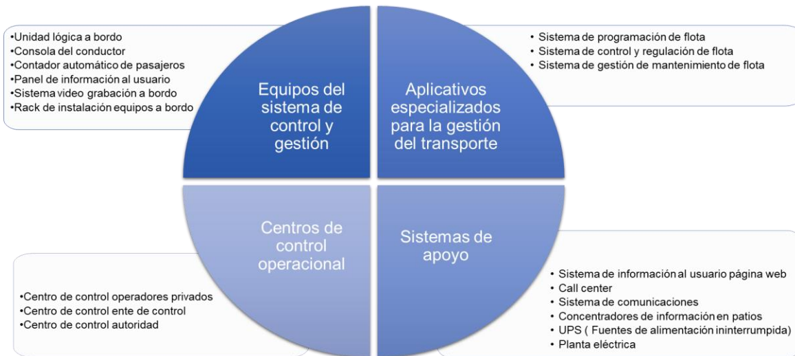
FIGURA 90. COMPONENTES Y ELEMENTOS DE SISTEMA DE GESTION Y CONTROL DE FLOTA
