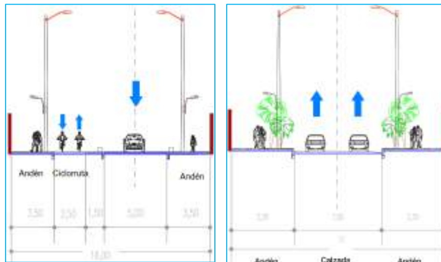
FIGURA 97. SECCIÓN TRANSVERSAL TIPO 15 Y 16 - PMMM 2011-2030
