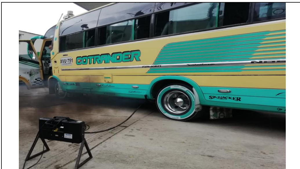
Foto 2. Medición de gases en empresa Cotrander.
