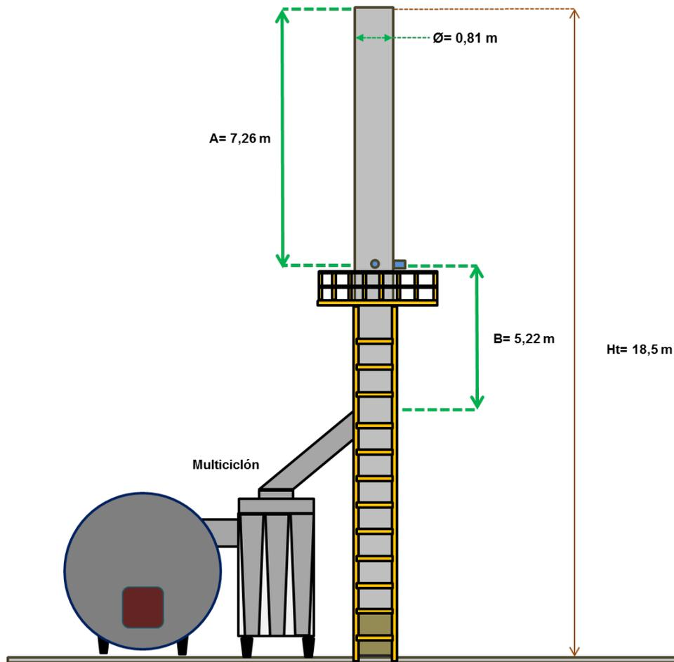
**Ilustración 4. Diagrama del ducto CALDERA JCT**
